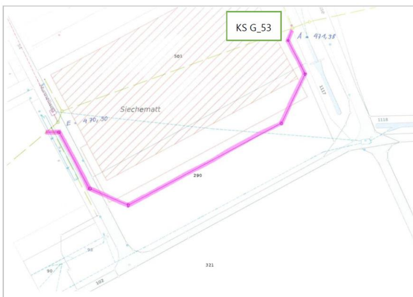
Abb. 15 Weiterverfolgte Variante Umlegung ARA-Leitung
