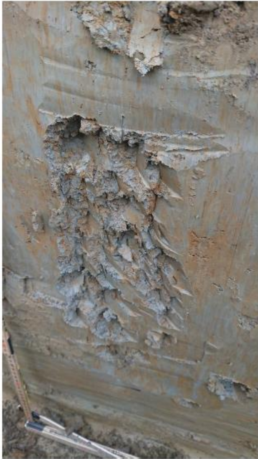
Abb. 6 Foto des sehr tonhaltigen, verässteten Untergrunds
