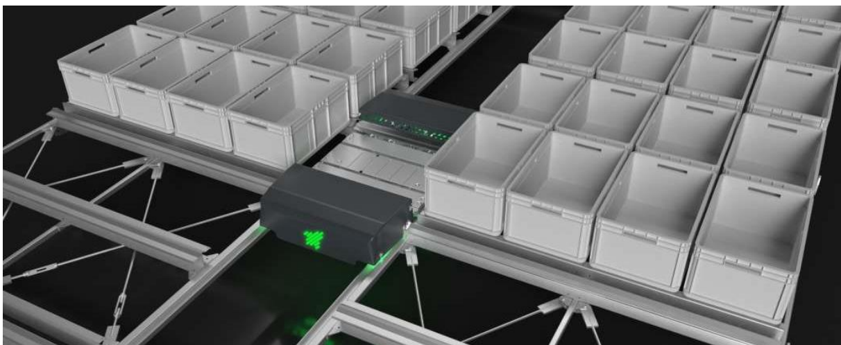
Abb. 10 Beispiel Prinzip Multishuttle-Lager (Quelle: www.logistra.de )
