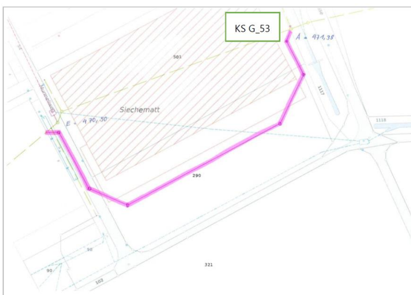
Abb. 15 Weiterverfolgte Variante Umlegung ARA-Leitung
